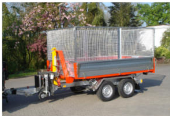
Maytec Abrollanhänger mit höhenverstellbarer Zugdeichsel
